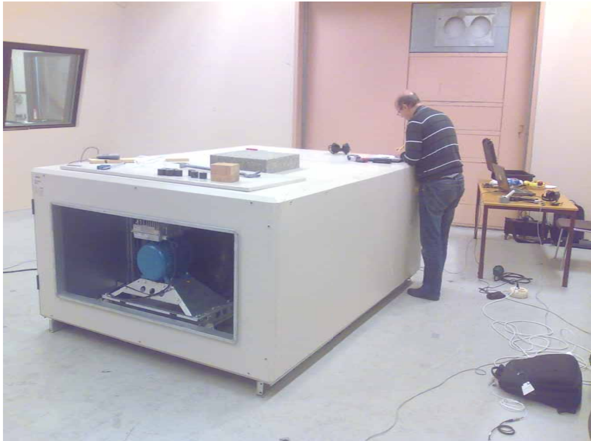
Figur 13. Vibrationsprovning av ventilationsaggregat hos SWEGON
